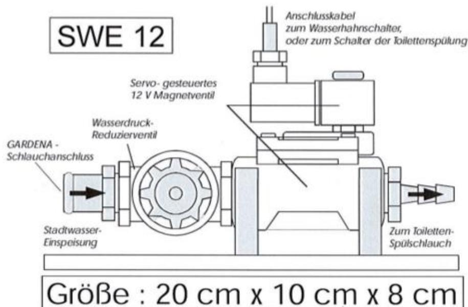
Wird einfach an den Anschlussschlauch sowie Anschlusskabel der Tauchpumpe angeschlossen, Stadtwasserschlauch anschließen, am Besten außerhalb des Wohnwagens montieren z.B. Fahrzeugboden
