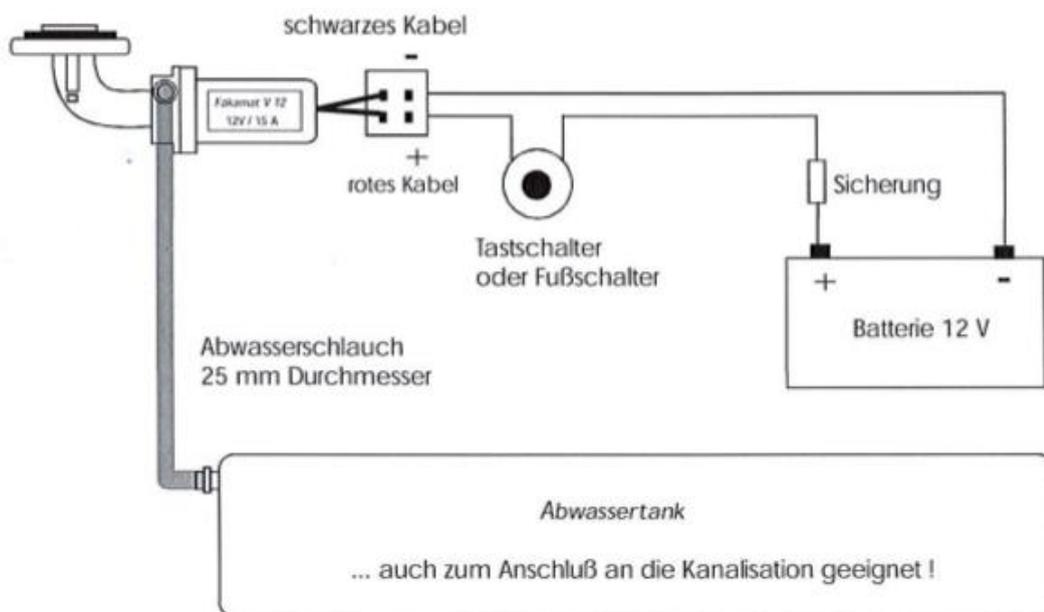
**Der Fäkamat kann zur Tankerweiterung, oder zum Anschluss an jedes Abwasserkanalsystem auf dem Campingplatz genutzt werden.**
